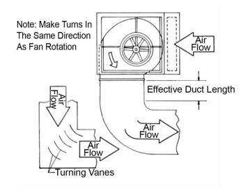
**FIGURE 103 -** RECOMMENDED DISCHARGE DUCT ARRANGEMENT WHEN TURNS ARE REQUIRED
