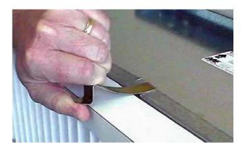
**FIGURE 121 -** POSITION PRE-FILTER IN FRONT OF FINAL FILTER
