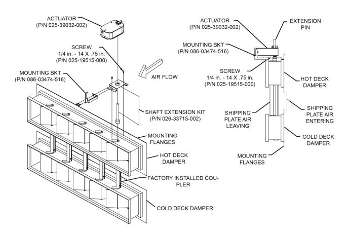
FIGURE 48 - INSTALLING MZ DAMPER
