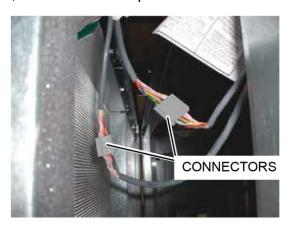
**FIGURE 35 -** ELECTRICAL CONNECTORS (CONNECTED)
