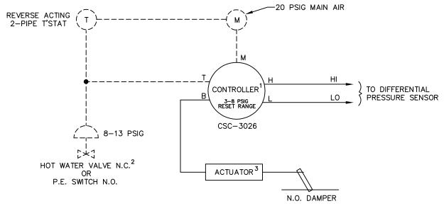
CONTROLLER REQUIRES FIELD CALIBRATION AND SET UP
